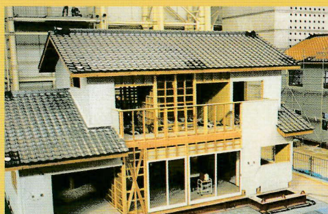
■阪神・淡路大震災の最大震度を再現した、木造軸組住宅の実物大振動実験 「平成7年11月～平成8年1月/香川県・(財)原子力発電技術機構」
